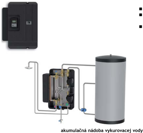
akumulačná nádoba vykurovacej vody
