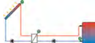
Vonkajší výmenník tepla, logika čerpadla
